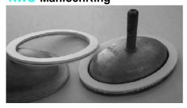
aus multidirektionalem ePTFE mit Edelstahl-Einlage zur sicheren und kaltwasserdichten Abdichtung von Hand-, Kopfund Mannloch-Deckeln in Behältern und Dampfkesseln bis 225 °C und 25 bar. Bauteilkennzeichen-Nr.: TÜV. D. 01 - 009. C
